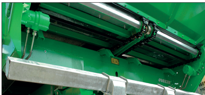
Napęd przenośnika dwoma silnikami hydraulicznymi
