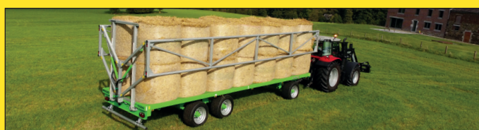
W opcji do modeli 8000D13, 10000T15 i 10000T20, boczne barierki hydrauliczne (2 jednodzielne) zapewniają bezpieczeństwo i szybkość użytkowania
