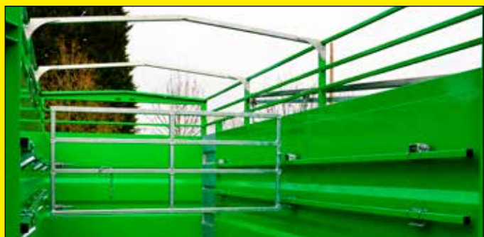
Przegroda wewnętrzna jednoczęściowa
