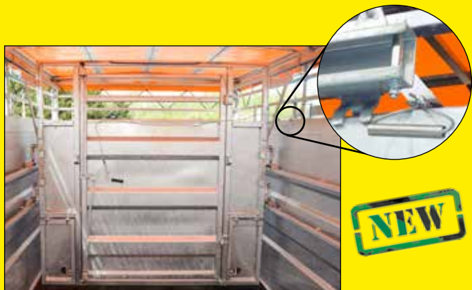
Wewnętrzne drzwi, wyposażone w uchwyt zapewniający bezpieczne otwieranie z zewnątrz
