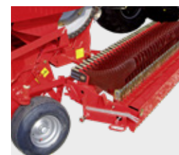
Rozkładana na bok belka nożowa
