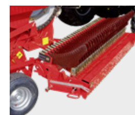
Rozkładana na bok belka nożowa
